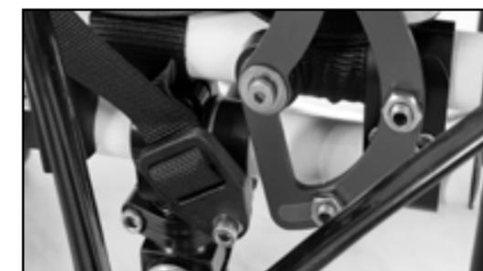
Image 67 Installez le support de sangle avec le boulon
