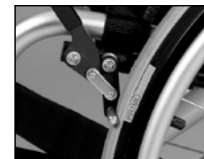
Image 44 Les blocages de roue appliquent une pression correcte
