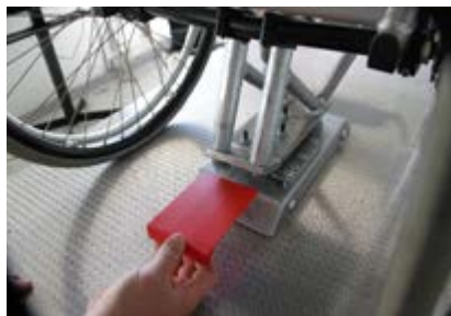
Image 12 Déverrouillage manuel de la station d'ancrage Dahl
