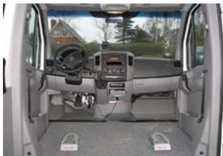
Image 11 Système d'ancrage Dahl dans un véhicule
